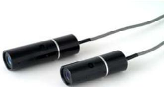
1軸方向の光を伸ばし、タテ/ヨコの比率を変化させて任意の距離にてビームの幅(太さ)と長さを設定します。光切断方式による3次元形状認識・測定用光源として使用されます。
